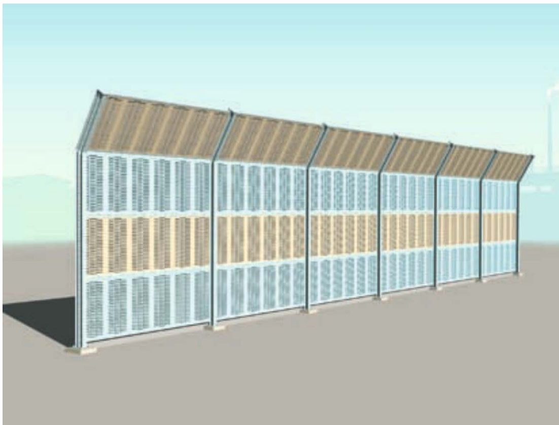
Рисунок 10. Непрозрачный одноуровневый шумозащитный экран. Стойки Г-образные. Общий вид
